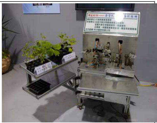
臺灣製造套管式蔬果種苗嫁接機
