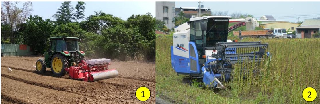
圖3. 胡麻機械播種-曳引機附掛播種機及機械採收-豆麥雜糧聯合收穫機(照片由苗栗區農業改良場王志瑄助理研究員提供)
