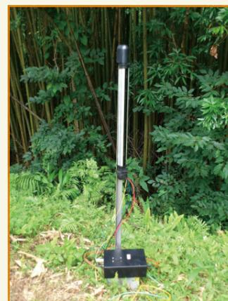
Wifi 無線通訊及紅外線光牆感測器設置情形
