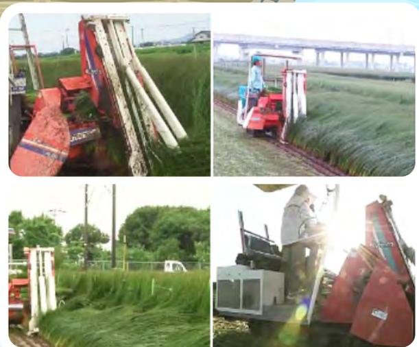
▲ 日本藺草機械收穫機作業程序，夾草捲入後切割後送堆疊，即使倒伏的也可以收割
