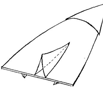
**碎土 犁頭** 構造：如上圖，是在舊型的犁頭中央上面，裝置兩片三角形鐵板，兩片鐵板的一邊互相焊着，犁頭，另外兩邊分別焊着在犁頭上，形成空心的三角
