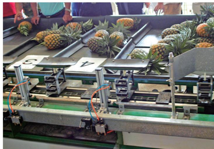
↑圖 2. 國內稍具規模的鳳梨集貨包裝場，以果實重量自動分級機，作業效率頗快，分級也較確實
